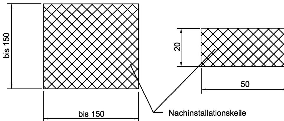
Mindestabstand von Keil zu Keil und zu den Bauteillaubungen  $\geq 5$  cm
