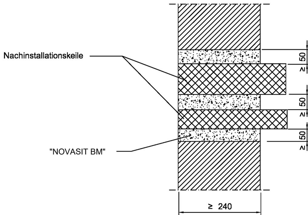
**Abmessungen der Nachinstallationskeile**
